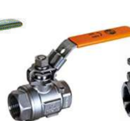
ΣΦΑΙΡΙΚΟΣ ΚΡΟΥΝΟΣ BSP 316/316/PTFE+GR, FB PN63, 2PC, ATEX, CE, TA LUFT EU (ΓΙΑ ΑΤΜΟ ΕΩΣ 11bar)
